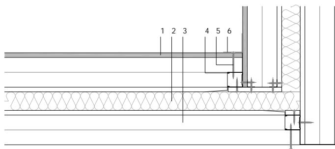
Détail de façade en coin entre panneaux sandwich Wallpanel CPY + laine minérale 40mm + Wallpanel YPY.
