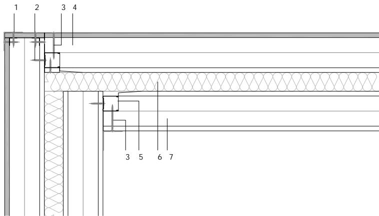
Détail de façade en angle entre panneaux sandwich Wallpanel CPY + laine minérale 40mm + Wallpanel YPY.
