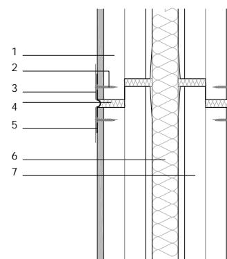
Joints de façade entre panneaux sandwich Wallpanel CPY + laine minérale 40mm + Wallpanel YPY.
