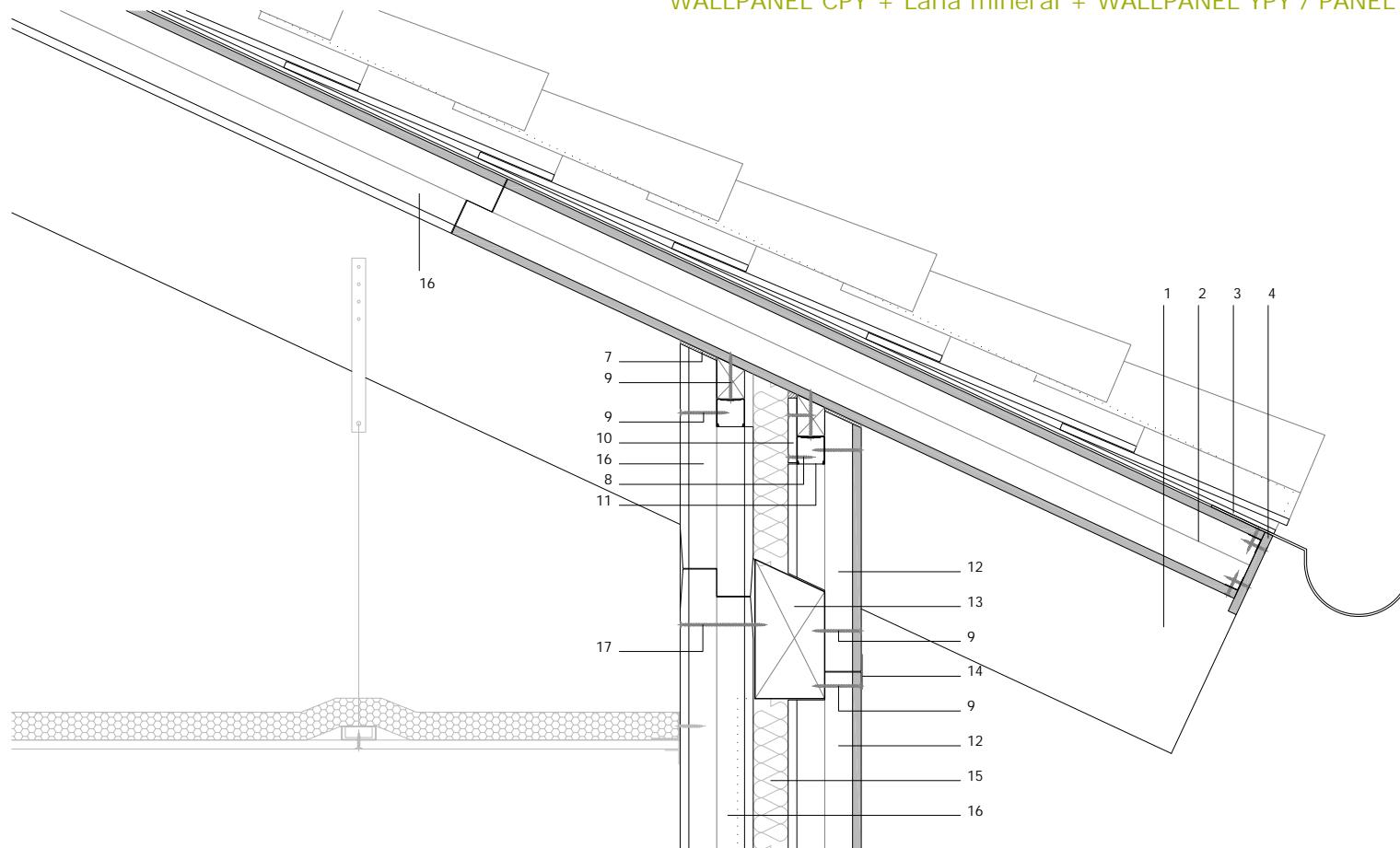
Encuentro de fachada formada por Wallpanel CPY + lana mineral 40mm + Wallpanel YPY con cubierta inclinada realizada con Tabiclick CPC + sistema de impermeabilización, sobre estructura de madera.
