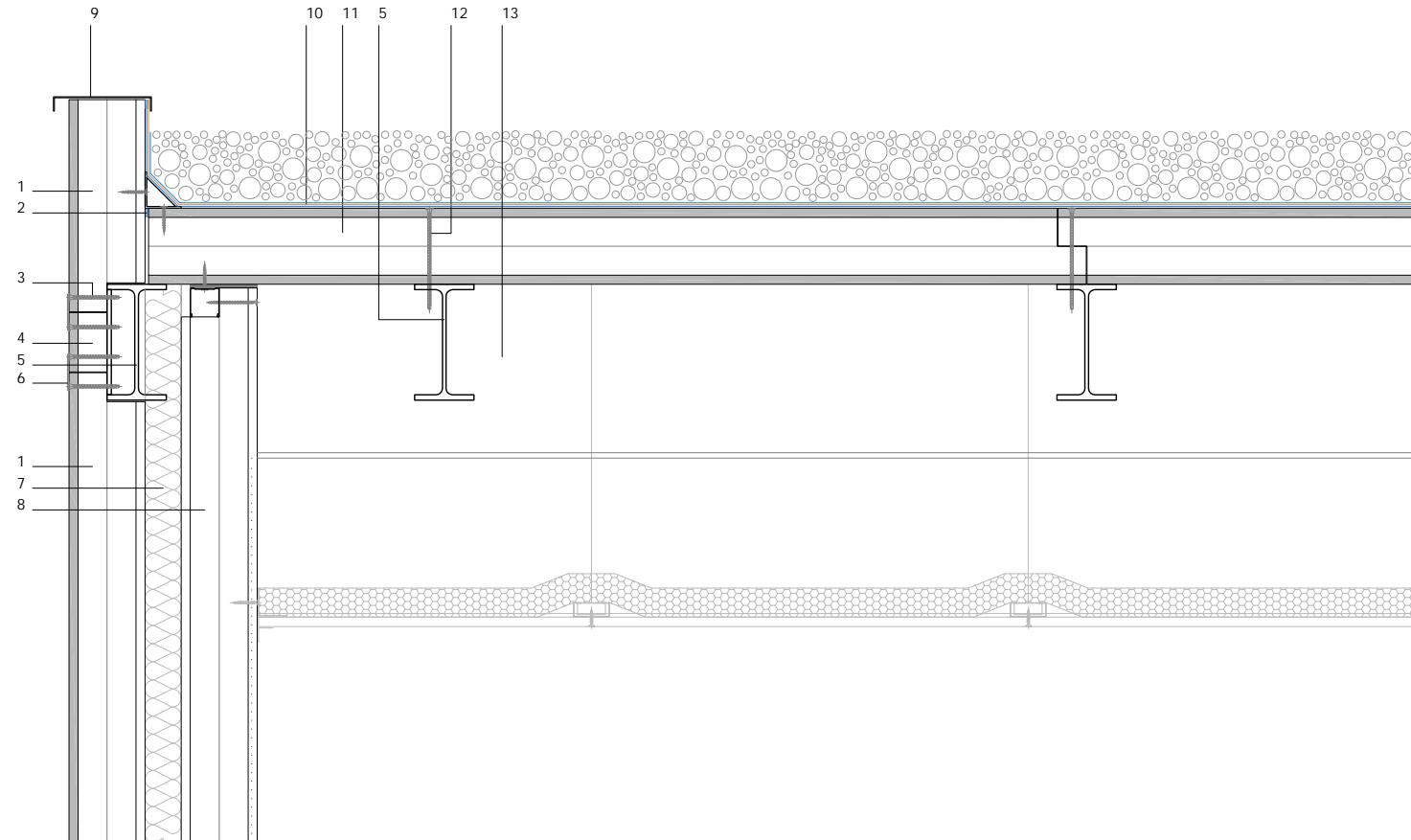
Encuentro de fachada formada por Wallpanel CPY + lana mineral 40mm + Wallpanel YPY con cubierta plana realizada con Tabiclick CPC + sistema de impermeabilización, sobre estructura metálica.
