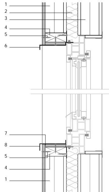
Encuentro de fachada formada por Wallpanel CPY + lana mineral 40mm + Wallpanel YPY con dintel y alféizar de carpintería de PVC.
