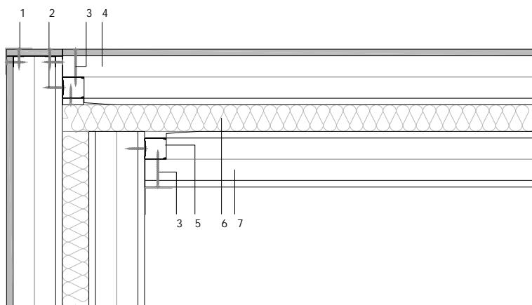
Encuentro de fachada en esquina entre paneles sandwich Wallpanel CPY + lana mineral 40mm + Wallpanel YPY.
