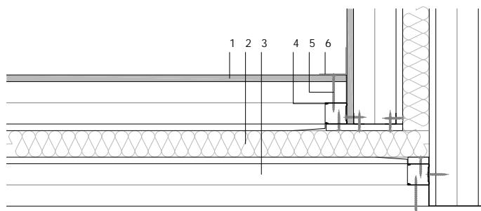
Encuentro de fachada en rincón entre paneles sandwich Wallpanel CPY + lana mineral 40mm + Wallpanel YPY.
